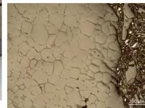
Refractario de  $MgO-Al_2O_3-C$  (con  $MgAl_2O_4$  formada *in-situ*)
