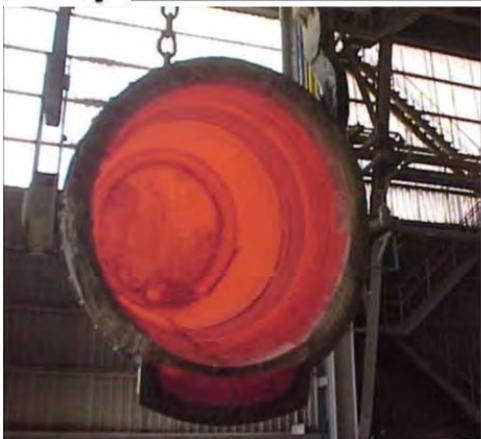
“Refractario es todo material capaz de soportar, a temperaturas elevadas, las condiciones del medio en que está inmerso, durante un periodo de tiempo económicamente rentable, sin deterioro excesivo de sus propiedades fisicoquímicas”
